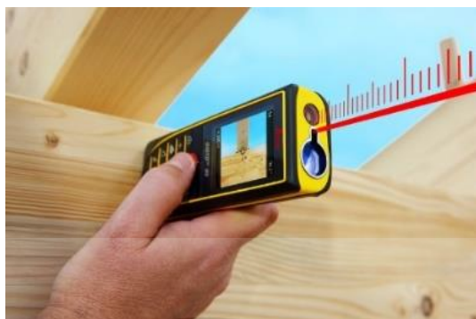
ภาพที่ 14 แสดงตัวอย่าง single point LiDAR : laser tape [11]
