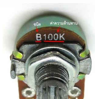
รูปที่ 2.36 การดูค่าความต้านทานของตัวต้านทานปรับค่าได้แบบวอลุ่ม
