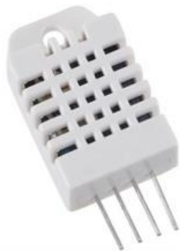
รูปที่ 2.3 Module DHT22
