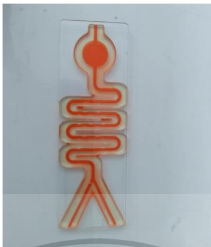
รูปที่ 4.29 ภาพการทดสอบการรั่วไหลของท่อในไมโครฟลูอิดิกที่ใช้เรซินเป็นตัวเชื่อมประสานระหว่าง กระจกและชิ้นงานเรซิน
