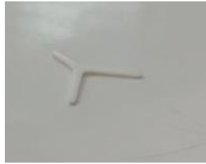
รูปที่ 4.14 การทดลองพิมพ์ท่อขนาดเล็ก
