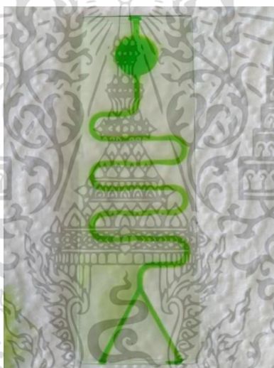
รูปที่ 4.30 ภาพการทดสอบการรั่วไหลของท่อในไมโครฟลูอิดิกที่ใช้ซิลิโคนเป็นตัวเชื่อมประสาน ระหว่างกระจกและชิ้นงานเรซิน
