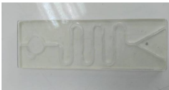
รูปที่ 4.25 ภาพอุปกรณ์ไมโครฟลูอิดิกหลังการประกบกระจกสไลด์
