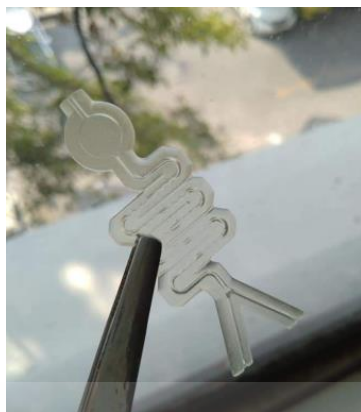
รูปที่ 4.21 ภาพไมโครฟลูอิดิกที่มีการตั้งค่า First layer time 120 วินาที และ Layer time 10 วินาที
