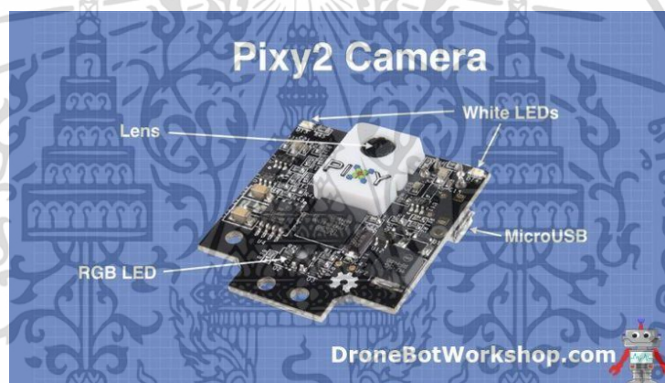
รูปที่ 2.19 ส่วนประกอบของ Pixy2 Camera
