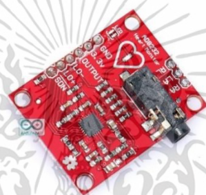
รูปที่ 2.23 ส่วนประกอบโมดูลวัดค่าคลื่นสัญญาณไฟฟ้าหัวใจ (AD8232)
