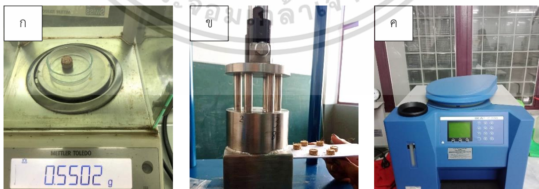
รูปที่ 3.3 การวัดค่าความร้อนด้วยเครื่อง Bomb calorimeter ชั่งน้ำหนักชีวมวล (ก) , อัดเม็ดพืชตัวอย่างด้วยเครื่อง (ข) , เครื่อง Bomb calorimeter (ค)
