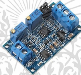
รูปที่ 2.14 Voltage to current converter module 1-5V to 0-20mA
