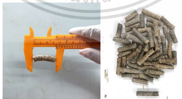
รูปที่ 3.14 การหาค่าความยาวของเชื้อเพลิงชีวมวลอัดเม็ด
