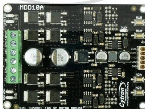
รูปที่ 3.21 แสดง Motor Drive Board ยี่ห้อ Cytron รุ่น MDD10A
