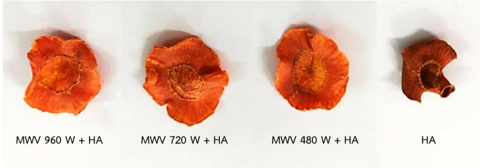
รูปที่ 4.5 แครอทซีฟที่ผ่านกระบวนการอบแห้งด้วยวิธีต่าง ๆ
