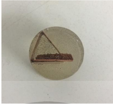
รูปที่ 3.5 ชิ้นงานที่ทดลองพ่นก๊าซอาร์กอนหลังจากการทำ Cold mount
