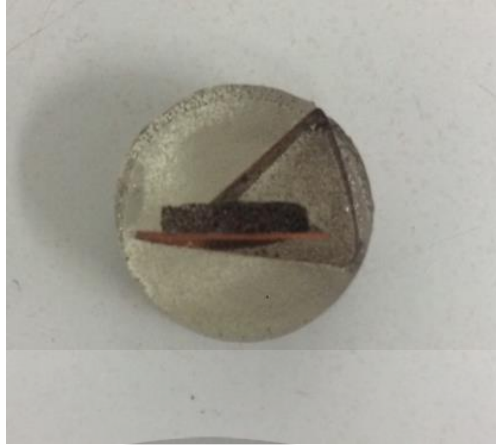
รูปที่ 3.3 ชิ้นงานทดลองหลังจากการทำ Cold mount
