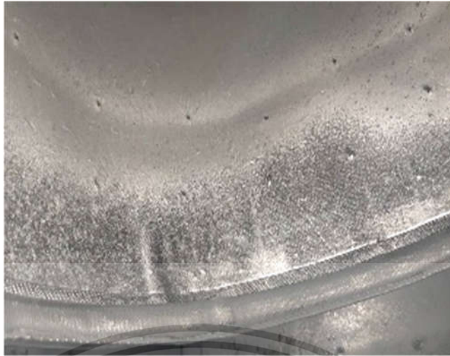
รูปที่ 3.26 ยางเสียหายจากการพ่นไอน้ำที่วชอบ
