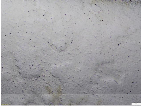
รูปที่ ผก 3 แสดงโครงสร้างจุลภาคของโลหะบัดกรีไร้สารตะกั่วชนิด 90.5Sn-1.5Cu-8Sb จากกล้องจุลทรรศน์แบบแสงที่กำลังขยาย 200 เท่า
