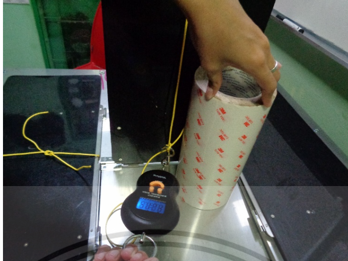
รูปที่ 3.20 การทดสอบวัดค่าแรงดันแผงพับ
