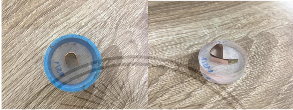
รูปที่ 3.3 ชิ้นงานที่ถูกขึ้นเรือนแบบเย็น (Cold mounting)
