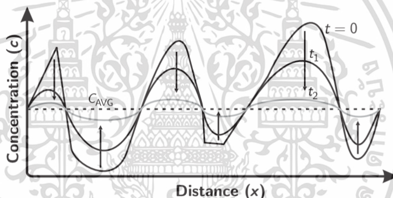
รูปที่ 2.11 กราฟความสัมพันธ์ระหว่างความเข้มข้นและระยะทางการแพร่ที่เกิดขึ้นภายใต้เงื่อนไขของเวลา [8]
