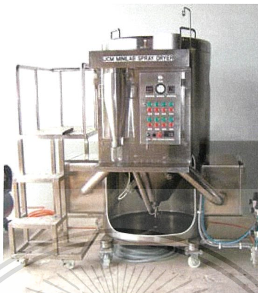
รูป 3.2 เครื่องทำแท่งแบบพ่นฝอย รุ่น JCM Minilab SDE-10
