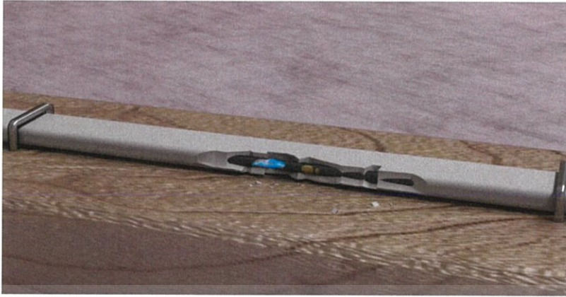
รูปที่ 2.6 สายไฟชำรุดเนื่องจากสัตว์กัดแทะ[15]
