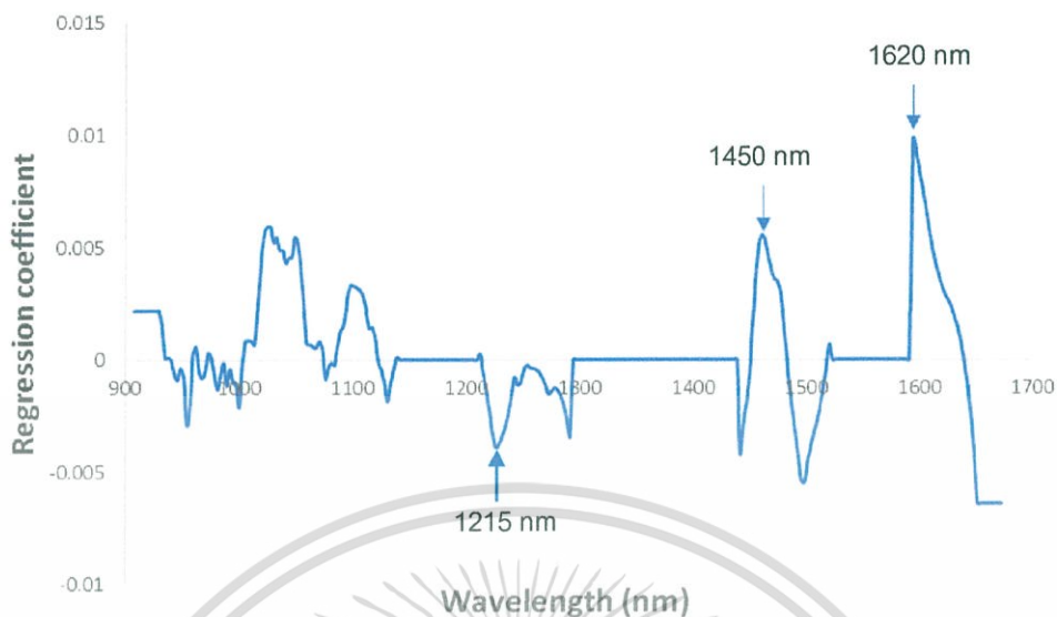
ภาพที่ 19 กราฟแสดงค่าสัมประสิทธิ์การถดถอยที่ความยาวคลื่นต่างๆของสเปกตรัมการดูดกลืนแสงที่ทำกรปรับด้วยวิธี First derivative ที่ค่าเฉลี่ยของการวัด 3 จุด โดยใช้เครื่อง FT-NIR Spectrometer
