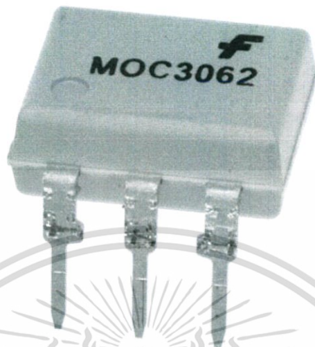
รูปที่ 3.5 6-Pin DIP Zero-Cross Optoisolators Triac Driver Output
