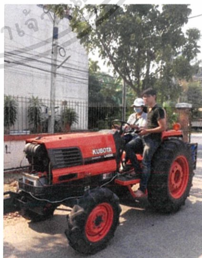
รูปที่ 24 การทดสอบภาคสนามหาความเร็วที่ได้จาก GPS เทียบกับความเร็วจริง
