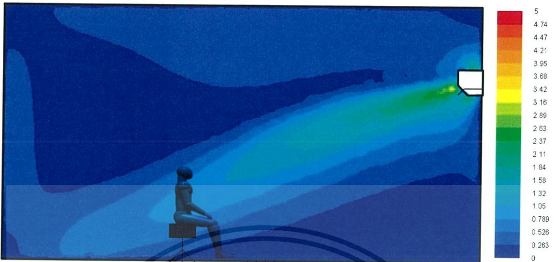
รูปที่ 5.2 แบบจำลองความเร็วลมในห้องที่ความเร็วลมระดับ 3 และใบปรับระดับที่ 1
