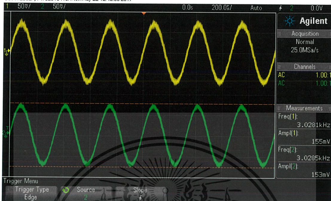
รูปที่ 4.15 กราฟแสดง Low pass filter ของวงจรฟังเสียงปอด
