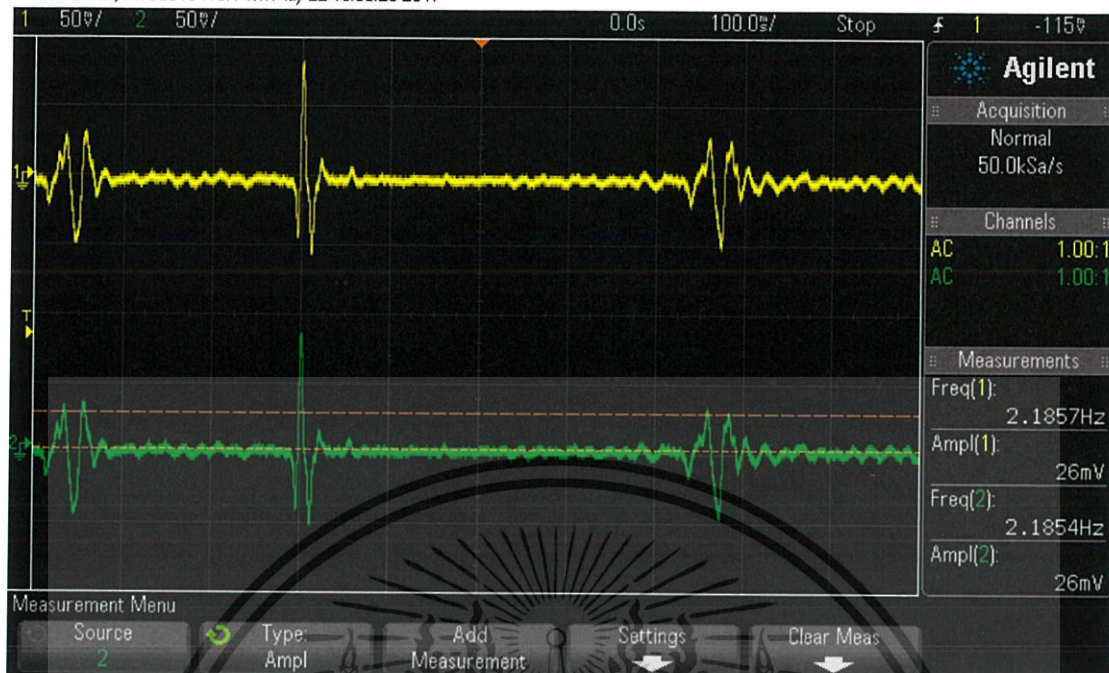
รูปที่ 4.11 สัญญาณเสียงหัวใจ Low pass filter
