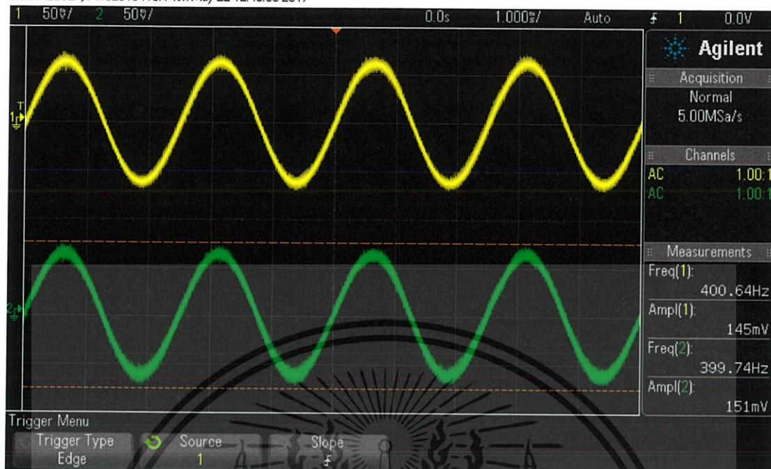
รูปที่ 4.7: กราฟแสดง Low pass filter ของวงจรฟังเสียงหัวใจ
