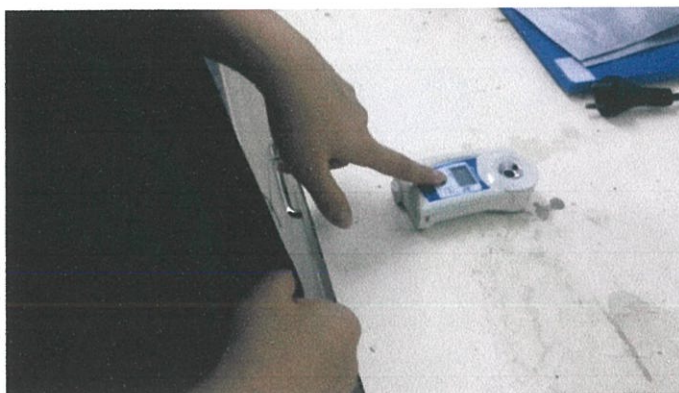
รูปที่ 3.8 การวัดปริมาณของแข็งที่ละลายได้ ทำได้โดยใช้เครื่อง Refractometer
