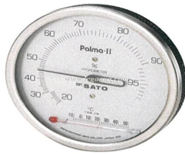
รูปที่ 2.1 ไฮโกรมิเตอร์แบบเส้นผม (Hair hygrometer)
