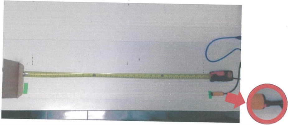
รูปที่ 4.2 ระยะทางมากที่สุดที่เซนเซอร์อินฟราเรดสามารถตรวจจับได้
