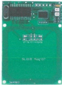
รูปที่ 3.13 RFID Module (I2C) รุ่น SL018 [5]
