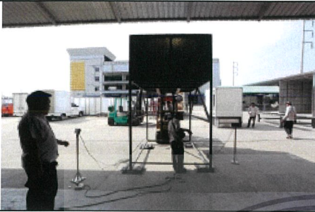
ก. การซิงน้ำโครงสร้างแท่นกตหลังคาแบบเดิมน้ำได้น้ำหนัก 500 กิโลกรัม
