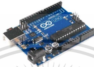
รูปที่ 2.4 แผงวงจรไมโครคอนโทรลเลอร์ อาร์ดูโน อูโน่ (Arduino UNO)
