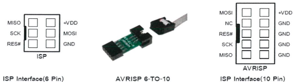
รูปที่ 3.5 การเชื่อมต่อกับขั้วต่อ AVRISP แบบ 10 Pin
