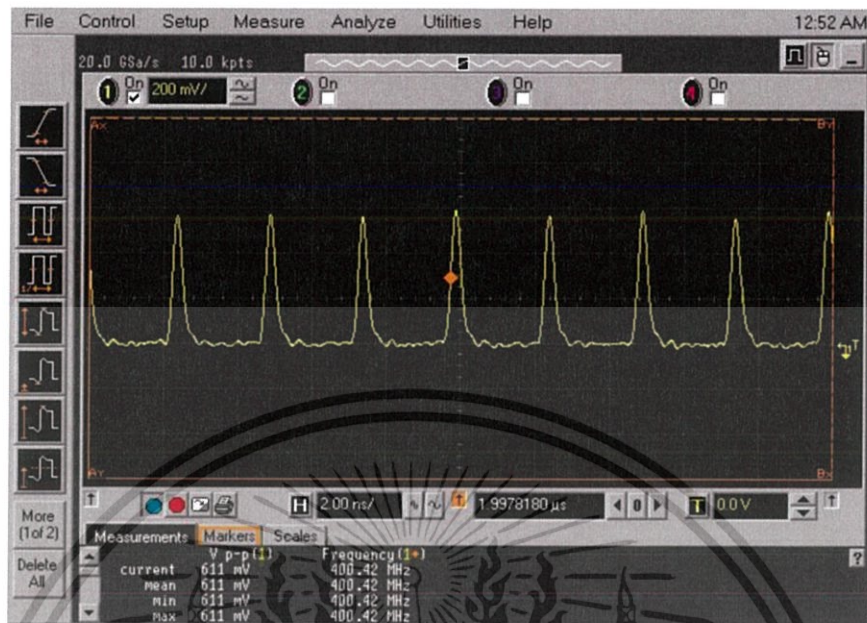
รูปที่ 4.11 การผลิตสัญญาณพัลส์ด้วยวงจรในรูปที่ 3.7 แสดงถึงขนาดของสัญญาณและช่วง PRF = 400.42\text{MHz} ขนาดของสัญญาณ 611\text{mV}
