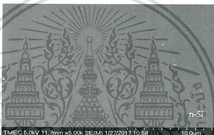
รูปที่ 4.5 ภาพถ่ายของตัวตรวจวัดแสงโครงสร้าง Al/n-Si/Al แบบร่องรูปตัวยู ถ่ายด้วยกล้อง จุลทรรศน์อิเล็กตรอนแบบส่องกราด (SEM) กำลังขยาย 5000 เท่า ที่บริเวณร่องรูปตัวยู
