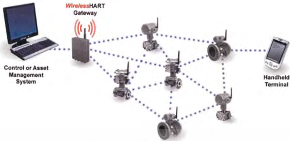
รูปที่ 2.34 โครงสร้าง WirelessHART
