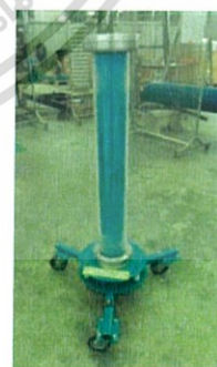
ข) ตัวอย่างโวลต์เตจติไวเดอร์ ชนิดความต้านทาน
