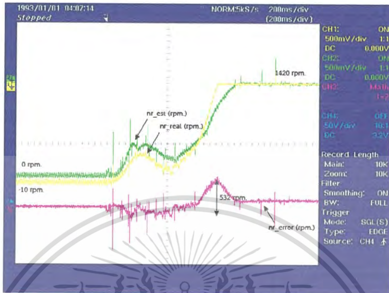
รูปที่ 4.15 ความเร็วมอเตอร์ขณะเริ่มสตาร์ทถึง 1420 รอบต่อนาทีและค่าความแตกต่างของความเร็วรอบ โดยการควบคุมแบบเวกเตอร์ที่ใช้ตัวตรวจจับความเร็ว
