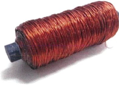
รูปที่ 3.4 แสดงขดลวดที่พันกับแกนเฟอร์ไรท์
