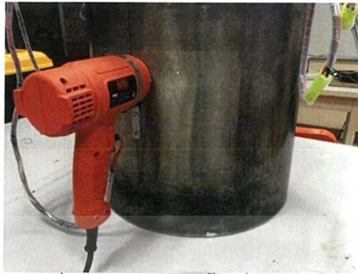
รูปที่ 3.9 แสดงการติดตั้งเครื่องเป่าลมร้อน ทำการเจาะรูที่กันหม้อเพื่อให้อุปกรณ์ที่หลุดร่วงลงสู่ภาดที่รองไว้
