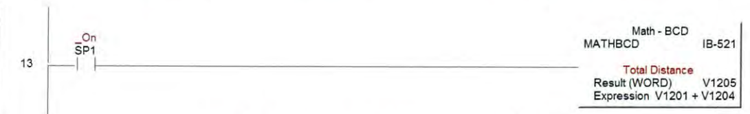
รูปที่ 3.38 แลตเตอรีไดอะแกรมบรรทัดที่ 13
