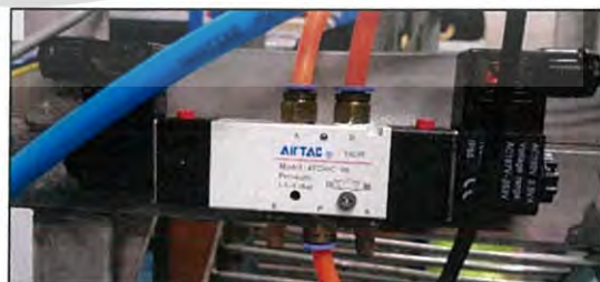
รูปที่ 3.12 สัญลักษณ์และโซลินอยด์วาล์ว แบบ 5/3 ตรงกลางปิด
