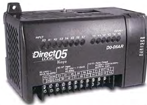
รูปที่ 3.4 พีแอลซีที่ใช้โปรแกรมกระบวนการควบคุมเครื่องอัดและขึ้นรูปเต้าหู้ ยี่ห้อ KOYO รุ่น DL05
