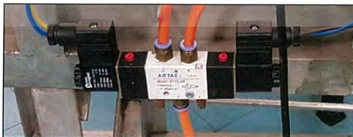
รูปที่ 3.2 ลักษณะของวาล์วควบคุมทิศทางการไหลแบบ 5/2 เพื่อเลือกทิศทางการทำงานของกระบอกสูบ
