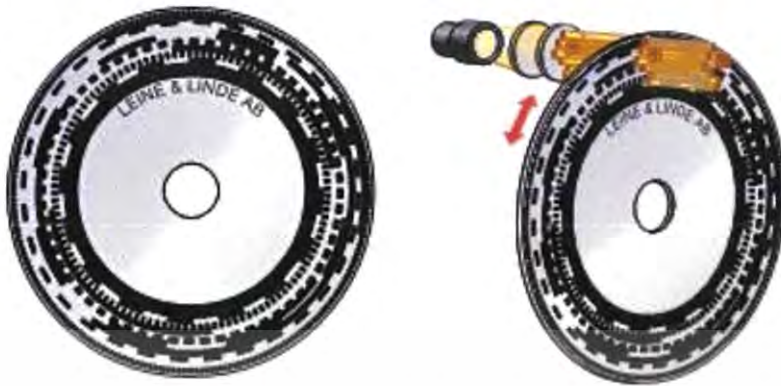
รูปที่ 2.19 ลักษณะของ Absolute Encoder
