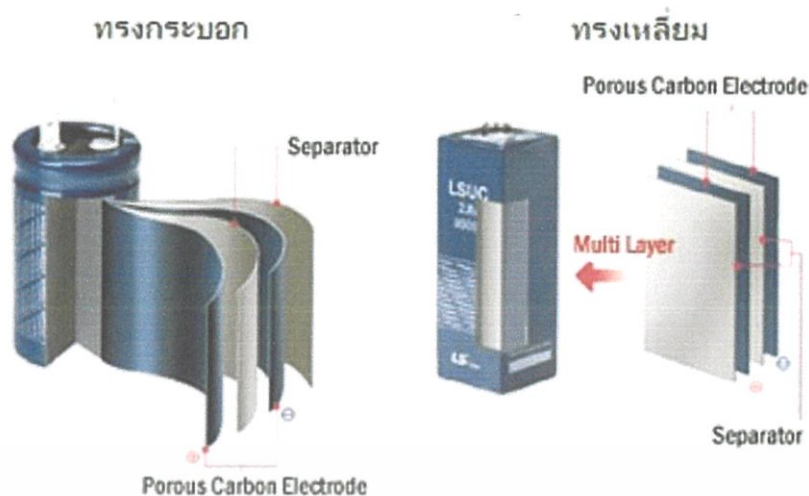
รูปที่ 2.17 ลักษณะภายในของตัวเก็บประจุทรงกระบอก (ซ้าย) และทรงเหลี่ยม (ขวา)
