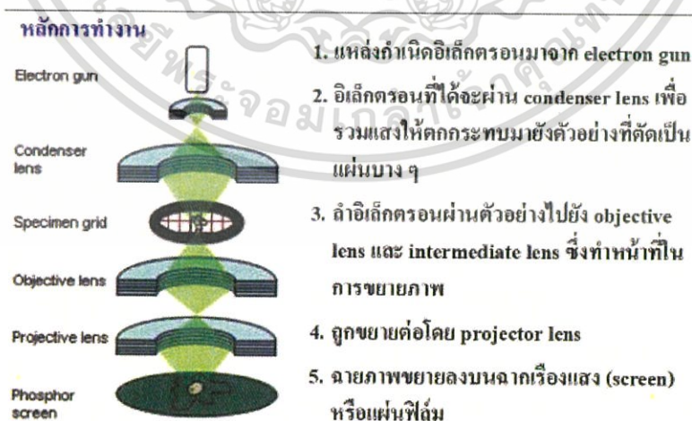
รูปที่ 2.27 หลักการทำงานของกล้องจุลทรรศน์อิเล็กตรอนแบบส่องผ่าน [14]
