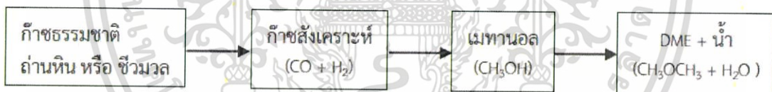
รูปที่ 2.2 กระบวนการสังเคราะห์ไดเมทิลอีเทอร์โดยผ่านกระบวนการขจัดน้ำออกของเมทานอล
