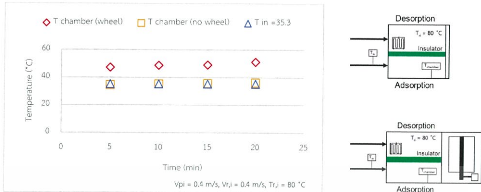
รูปที่ 4.4 ผลการศึกษาผลของความดันตกคร่อมของวงล้อดูดความชื้นต่ออุณหภูมิอากาศชื้นขาเข้า
