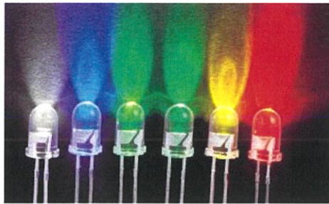
รูปที่ 2.10 ภาพตัวอย่างทิศทางของแสงจากหลอดไดโอดเปล่งแสง
