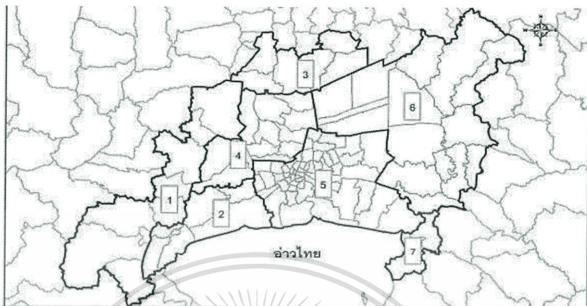
แผนที่แสดงการแบ่งโซนพื้นที่แอ่งกรุงเทพเพื่อการออกแบบ อาคารต้านทานแผ่นดินไหว
