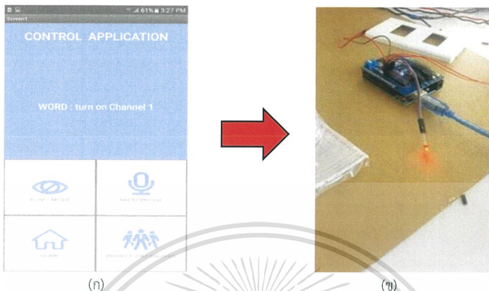
รูปที่ 4.4 แสดงการทำงานในคำสั่งเปิด (Turn On) ของแต่ละช่องการควบคุม (ก) คำสั่งเปิด (Turn On) ใช้งานที่ถูกต้องแสดงบนแอปพลิเคชัน (ข) หลอดไฟ LED ที่ได้รับคำสั่งควบคุมการใช้งานมาจากแอปพลิเคชัน
