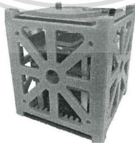
รูปที่ 2.2 แบบจำลองทางวิศวกรรมของดาวเทียมคิวบ์แซท
