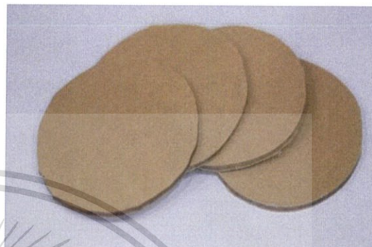
รูปที่ 3.16 เพรสบอร์ดเส้นผ่านศูนย์กลาง 85 mm
