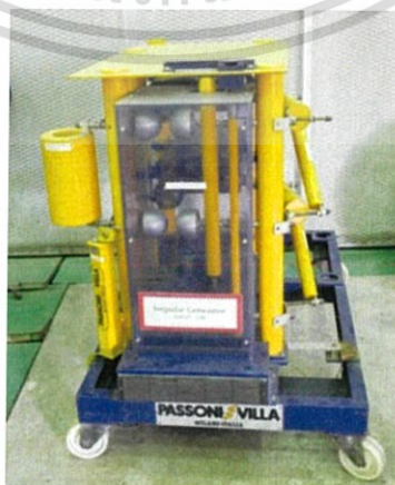
รูปที่ 3.19 ชุดกำเนิดอิมพัลส์ขนาด พิกัดแรงดัน 200 kV
