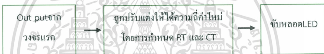
รูปที่ 19 แสดงบล็อกไดอะแกรมของ วงจรสวิตซ์ไดร์หลอด LED หลายความถี่
