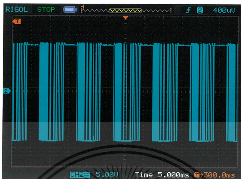
รูปที่ 5.29 สัญญาณขับสวิตช์ ScC ในวงจรเมตริกซ์คอนเวอร์เตอร์
