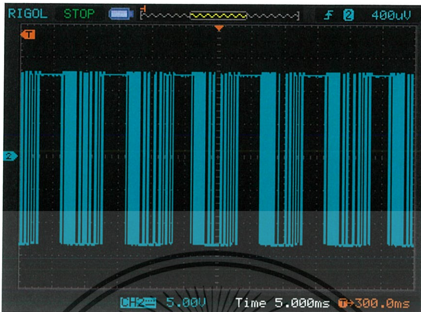
รูปที่ 5.25 สัญญาณขับสวิตช์ SbB ในวงจรเมตริกซ์คอนเวอร์เตอร์
