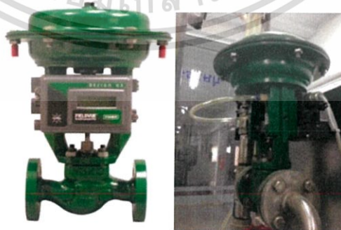
รูปที่ 2.30 อุปกรณ์ควบคุมอัตราการไหลประเภท Control Valve ชนิด Globe Valve แบบ Equal percentage[25]
