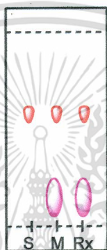
รูปที่ 3.9 แผ่นทินเลเยอร์โครมาโทกราฟีของกรดดีไฮโดรโคลิค 14 เปรียบเทียบกับสารสกัดหยาบ S หมายถึงสารตั้งต้น; M หมายถึง จุดผสมระหว่างสารตั้งต้นและสารสกัดหยาบ; Rx หมายถึง สารสกัดหยาบที่ได้จากปฏิกิริยาระหว่างกรดดีไฮโดรโคลิค 14 กับเชื้อรา
