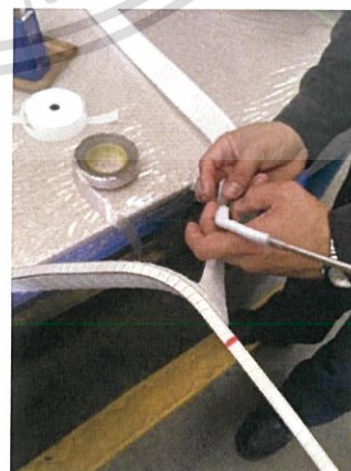
รูปที่ 3.33 พันเทปโพลีเอสเตอร์รอบต้นขด
