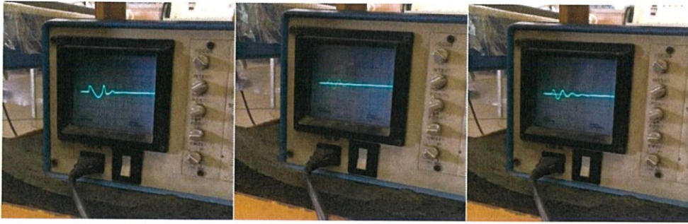
รูปที่ 3.45 ออสซิลโลสโคปแสดงสัญญาณการเปรียบเทียบเสิร์จ
