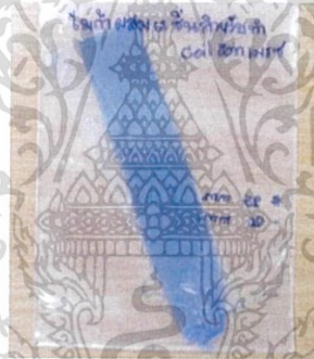
รูปที่ 2.13 ไมก้าเทปผสมเรซินสำหรับกระบวนการเรซินริช [4]
