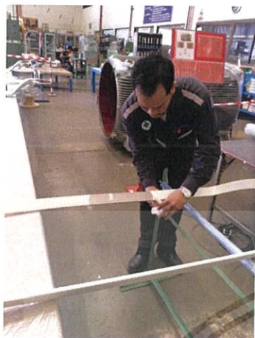
รูปที่ 3.34 ตัดผ้าดิบจากตรงกลางออกแล้วติดด้วยไมลาฟิล์ม
