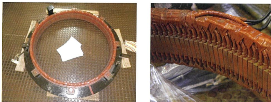
รูปที่ 3.17 สเตเตอร์ของเครื่องกำเนิดไฟฟ้าชนิดแม่เหล็กถาวร
