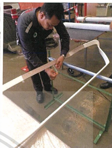
รูปที่ 3.34 ตัดผ้าดิบจากตรงกลางออกแล้วติดด้วยไมลาฟิล์ม
